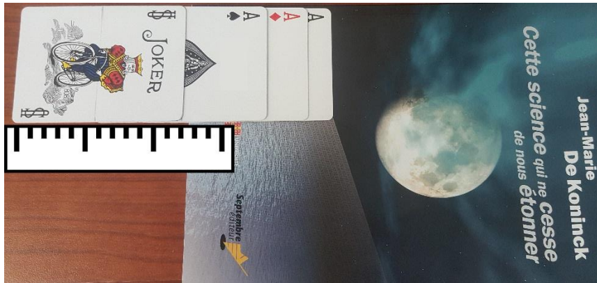
Figure 7 Une carte mesurant 12 unités atteint un surplomb est d'environ 12,5 unités, l'extrémité de la dernière carte est donc à environ 25/24 longueur de carte du bord du livre.
